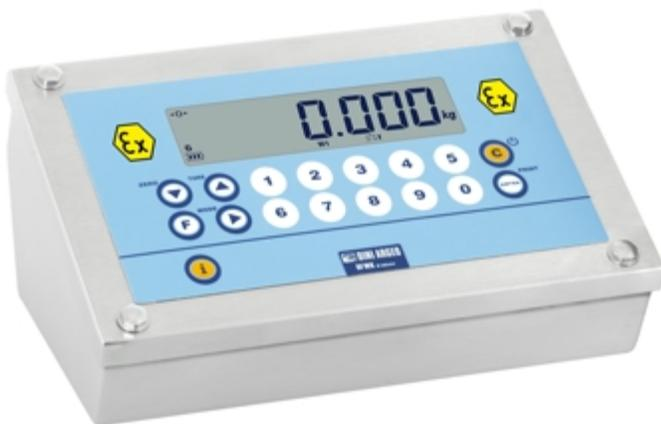
Wäge-Indikator mit Edelstahl-Gehäuse IP65, geeignet für explosionsgefährdete Bereiche, ATEX-Kennzeichnung: ATEX II 2G Ex ia IIC T4 Gb für Gase ATEX II 2D Ex tb IIIC T197°C Db IP65 für Staubpartikel.
