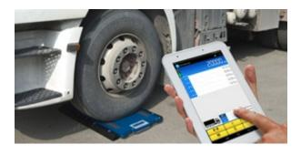
Beispiel: Anwendung einer Wireless-Plattform, mit Option WWSDUAL mit analoger Plattform, Bluetooth BLTH und der App "DINI SMART AXLE Weighing":
