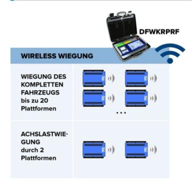
Anwendung mit kabellosen Plattformen und DFWKRPRF Gewichtsanzeige, für die Visualisierung und Druck des Gewichts durch Fernanzeige.
